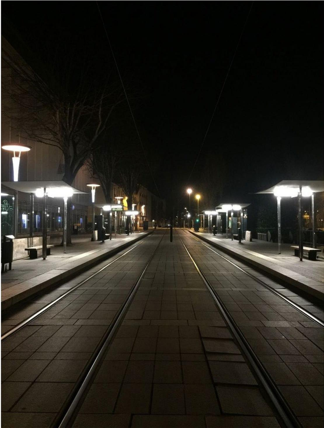
Utilisation d'un tubulaire en version PMMA pour l'éclairage d'une station de tramway
