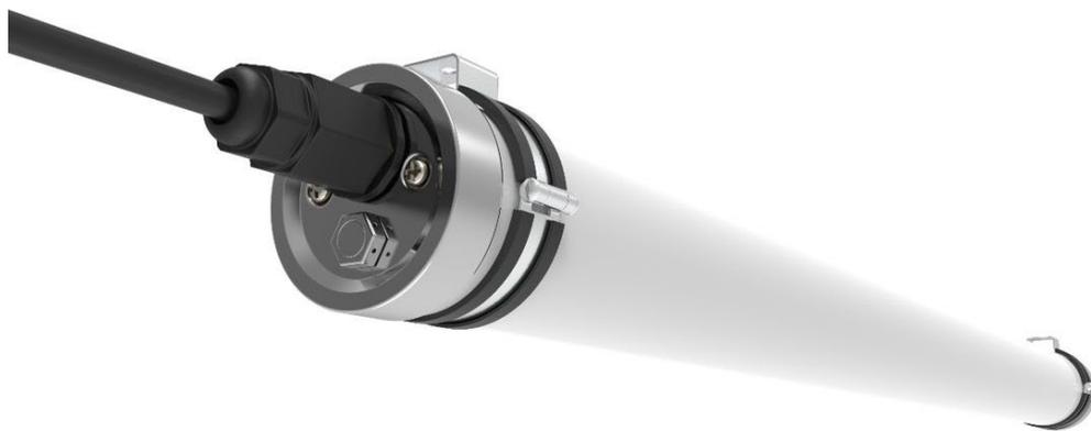
La [gamme OPALINE Tubulaire Access](#) est actuellement proposée en standard en IP69K IK10, deux flasques et clips de fixation anti-rayure en inox 304, un raccord rapide. Le raccordement sans outils permet à nos clients un gain de temps de pose conséquent. Son rendement lumineux jusqu'à 150lm/W est disponible de 20 à 50W, de 60 cm à 150 cm. Equipés de joints en silicone contre la pénétration de liquide et solide. Le tout pouvant fonctionner jusqu'à -40°C.
