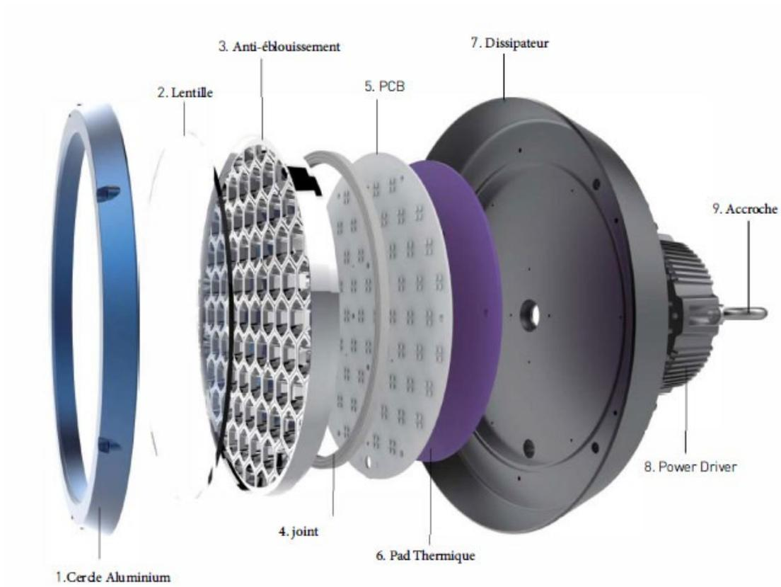
**Quartz Compact AHD** est une armature disponible en 100w, 150w et 200w. Elle embarque une technologie Led éprouvée et un système de diffusion de la lumière en nid d'abeille permettant de réduire l'UGR. Disponible en UGR19 à la demande, ce système garantit le confort de travail tout en gardant une grande qualité d'éclairage.
